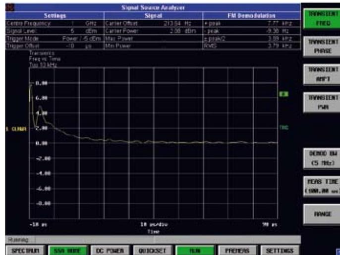
*Einschwingvorgang eines Generators*
