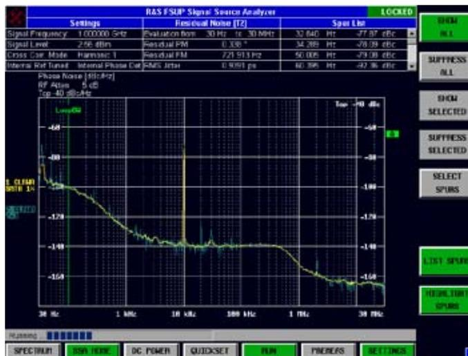
Typische Phasenrauschmessung mit der Phasendetektormethode – Signalfrequenz, Pegel und Residual Noise werden angezeigt
