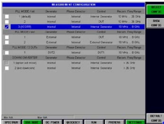
Einfache Einstellung des Messaufbaus im Konfigurationsmenü mit Anzeige des empfohlenen Messbereichs
