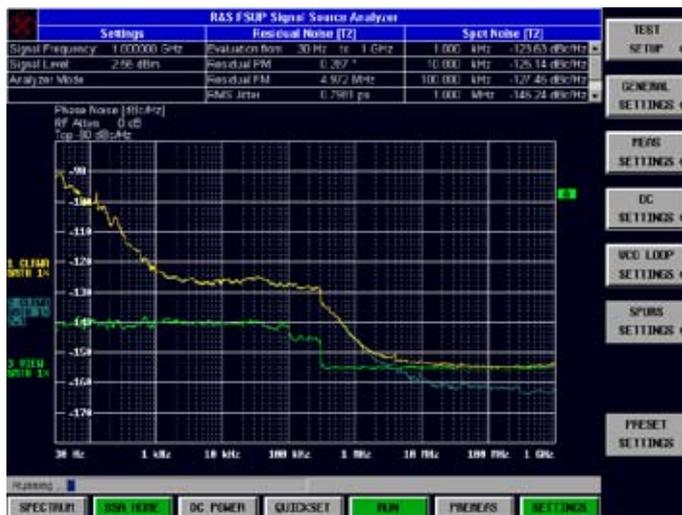
Eine Phasenrauschmessung mit dem Spektrumanalysator. Die blaue Kurve zeigt das Messergebnis bis zu einer Offset-Frequenz von 1 GHz, das Eigenrauschen (grüne Kurve) wird vom gemessenen Signal (gelbe Kurve) abgezogen
