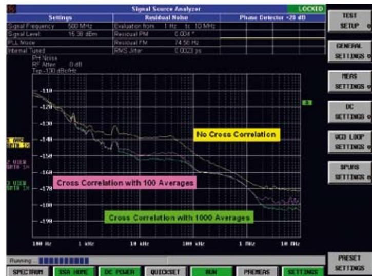
Verbesserung der Empfindlichkeit durch Kreuzkorrelation. Das Bild zeigt eine Messung des Phasenrauschens ohne Kreuzkorrelation (gelbe Kurve) und mit Kreuzkorrelation (100 und 1000 Mittelungen)
